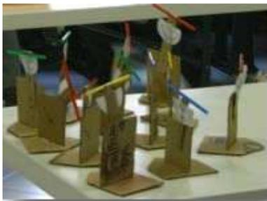
(realizzato con una cannuccia) sorretto da un semplice sistema di stazionamento fatto con alcuni pezzi di cartone. Applicando al supporto un goniometro si ottiene una scala graduata che permette di misurare la distanza di una stella dallo zenit e la sua altezza sull'orizzonte.
